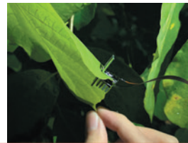
開発した植物モニタリングデバイス。
