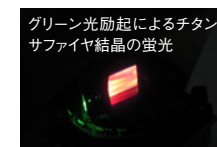
グリーン光励起によるチタンサファイヤ結晶の蛍光
